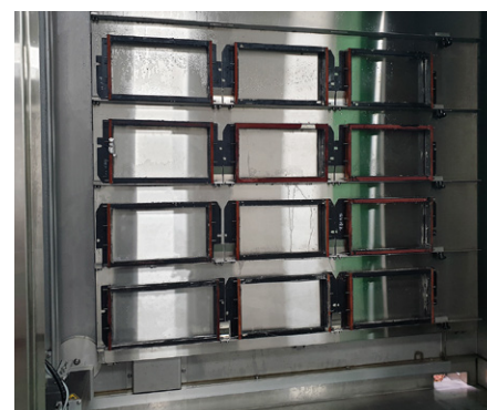
Mithilfe der Mutterrahmen lassen sich mehrere kleine Siebe in einem Durchgang belichten.
