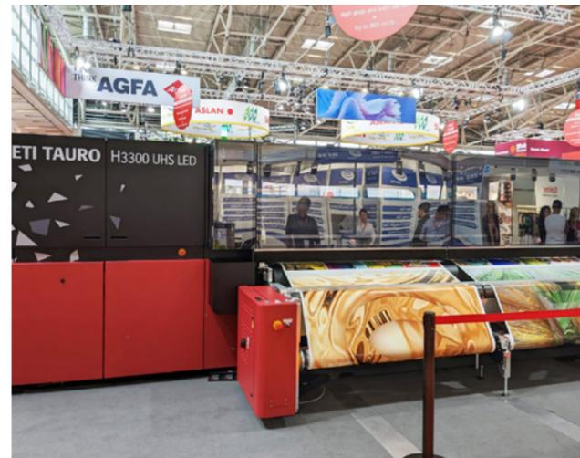
Das Rolle-zu-Rolle-Druckmodul Flex RTR ist bis zu einer Druckgeschwindigkeit von 905 Quadratmetern die Stunde ausgelegt.
